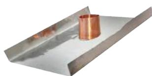
Tonda a pendenza fissa con scarico condensa e tubo elettrosaldato. Con inbocco in rame e base in piombo
