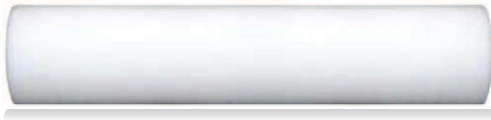
Polietilene espanso non reticolato a cellule chiuse, densità 20 Kg/m<sup>3</sup>, adatto ad essere utilizzato come strato resiliente nella posa in opera di parquet flottanti e pavimenti galleggianti.
